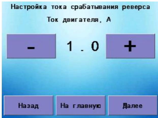
В данном меню производится установка порогового значения тока двигателя привода шнека (поршня), при котором происходит реверс направления вращения шнека (поршня) для устранения заклинивания в случае попадания в топливо кусков породы и т.п. Для выбора корректного значения тока рекомендуется произвести пробный запуск углеподачи в работу с питателем заполненным топливом, используя меню «Управление шнеком».
